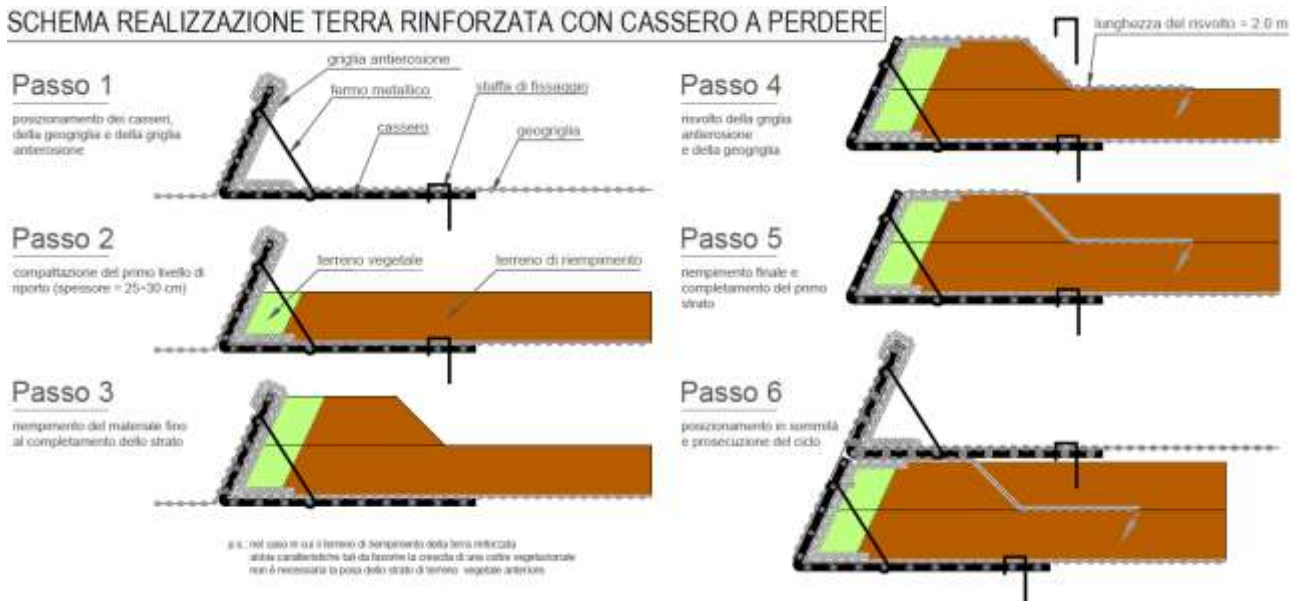
Figura 3.4-6 – Schema di realizzazione della terra rinforzata con cassero a perdere
